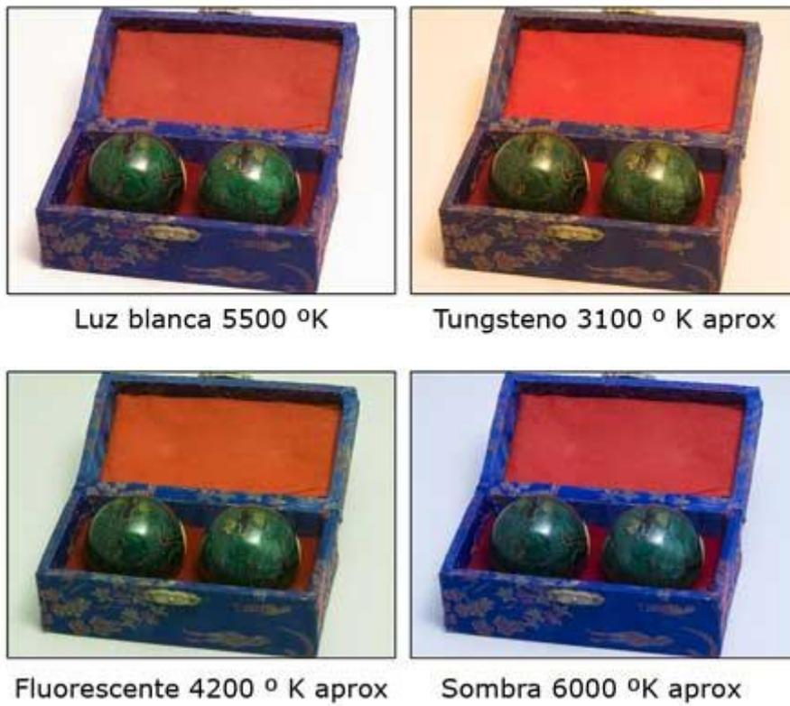
Figura 3. Simulación del efecto producido por las distintas temperaturas de las fuentes de luz de sobre un objeto con colores primarios, fotografiando siempre sin corrección en la cámara.
